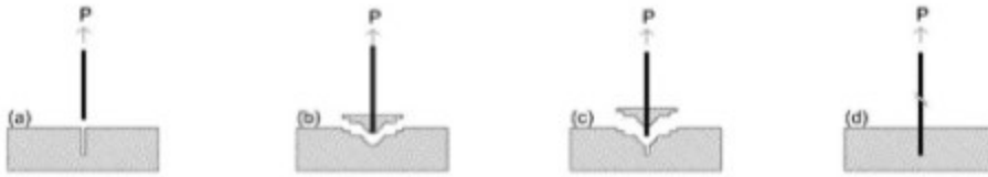
Görsel 2. Kimyasal Ankrajların Göçme Türleri (a) Tam Sıyrılmalı Göçme, (b) Konik Göçme, (c) Kısmi Sıyrılmalı Göçme, (d) Ankraj Kopması [3, 4]
