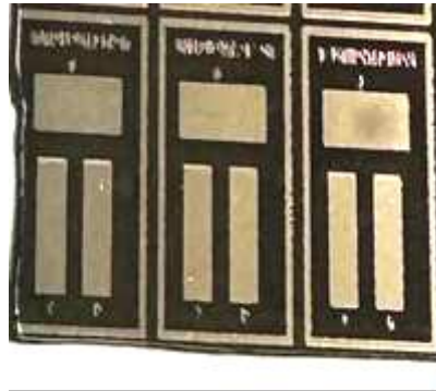
Görsel 1. PANI/ZnO NRs kompozit kanal FET sensör yapısı
