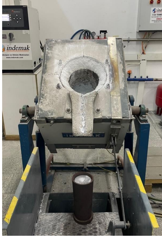
Görsel 1. Alaşımların üretiminde kullanılan indüksiyonlu ergitme ocağının fotoğrafı
