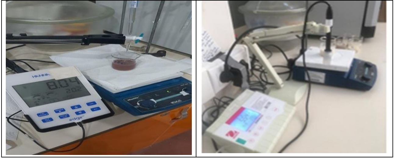
Görsel 3. A. Titrasyon asitliği (sağ) ve B. pH tayini (sol)
